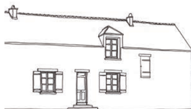
A l'origine, les longères ne sont pas habitées à l'étage ; les ouvertures peuvent néanmoins être transformées pour éclairer les combles
