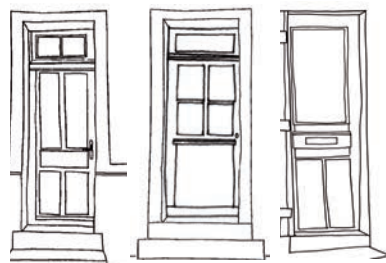
Portes d'entrée avec partie supérieure vitrée protégée par une ferronnerie ou imposte vitrée droite surmontée parfois d'une marquise
