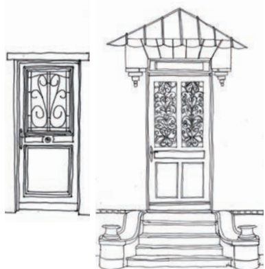
Portes d'entrée avec partie supérieure vitrée protégée par une ferronnerie ou imposte vitrée droite surmontée parfois d'une marquise
