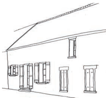
Les ouvertures des longères sont disposées sans ordonnancement précis sur la façade. Leurs linteaux ne sont pas tous alignés horizontalement
