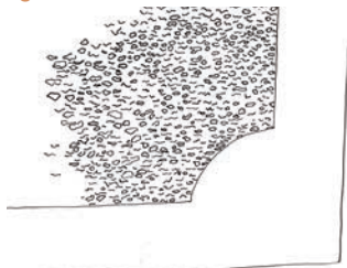
Détail d'un enduit tyrolien avec l'enduit lissé
